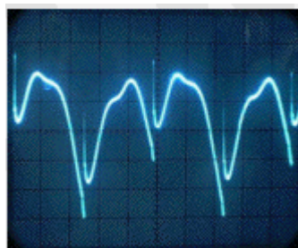
Fig. 2.17 Current output of MabuchiFF- 030 PN motor
