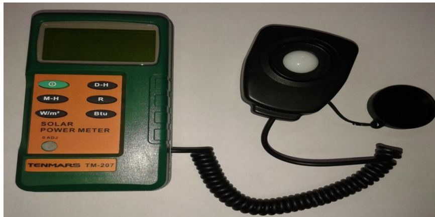
Fig.45 Solar power meter
