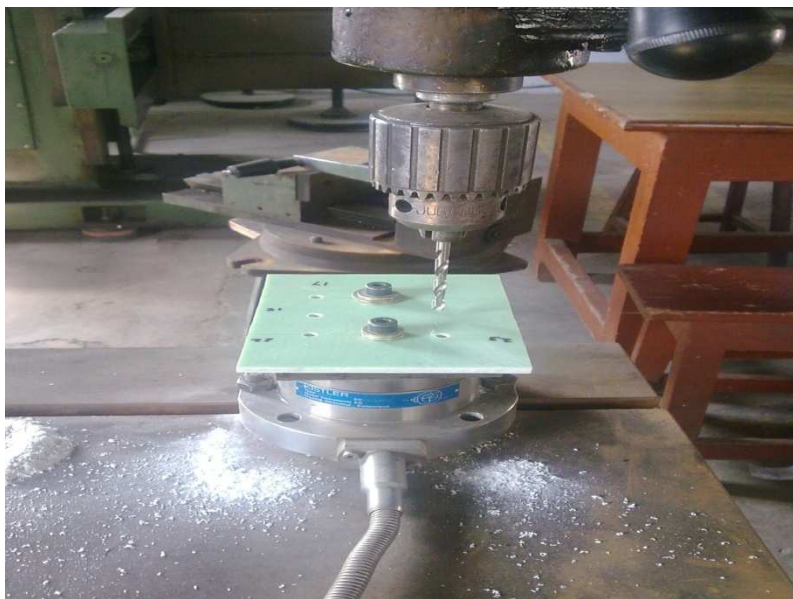
Fig. 3.7 Dynamometer (Kistler, Type 5070A)
