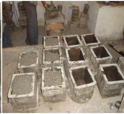
f) Pouring of mix
