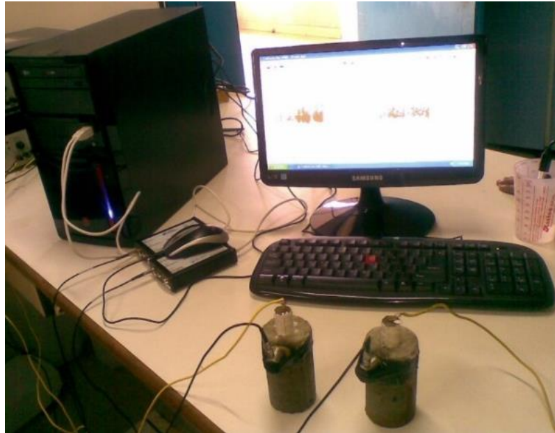
Fig. 3.17. Actual laboratory Set up for AE Testing
