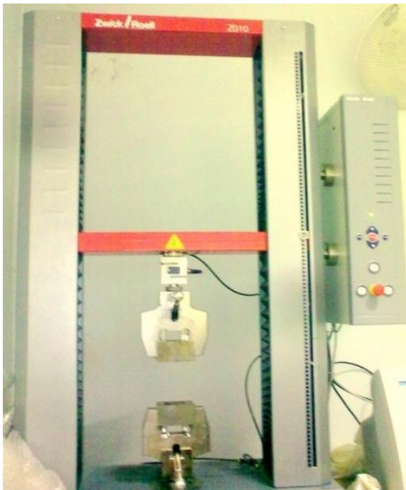
Fig. 4.12: UTM tensile setup
