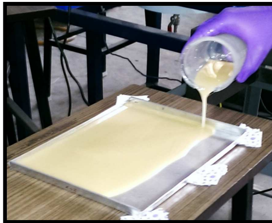
Fig. 3.12 Pouring mix in the mold
