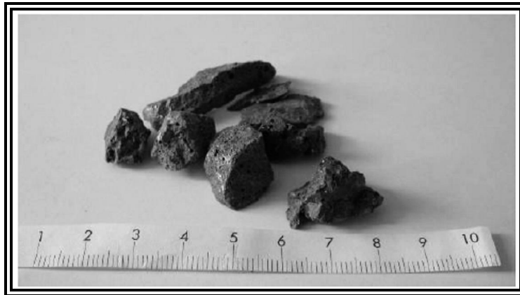
Fig. 2.1 Cupola Furnace Slag
