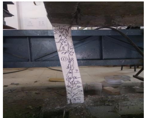
(d) Ductile behaviour of column D
