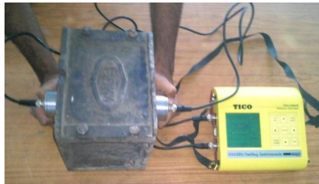
Fig 4.4 Actual UPV testing
