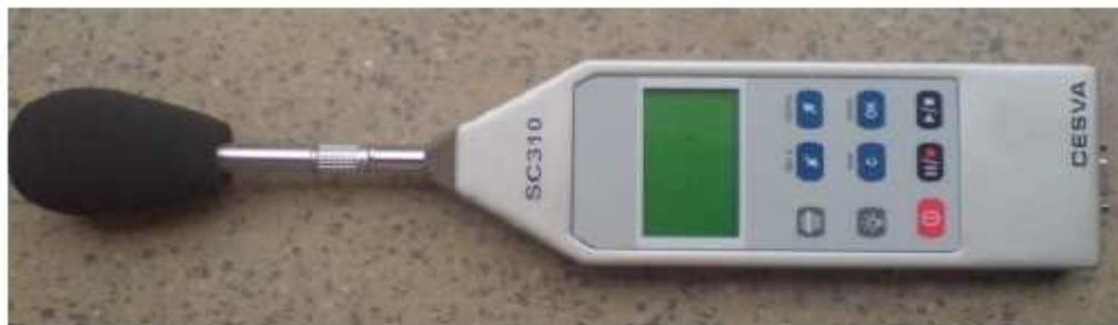
Fig. 5.4 Sound level meter
