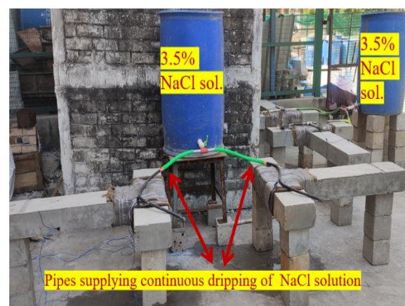
(d) Setup for accelerated corrosion
