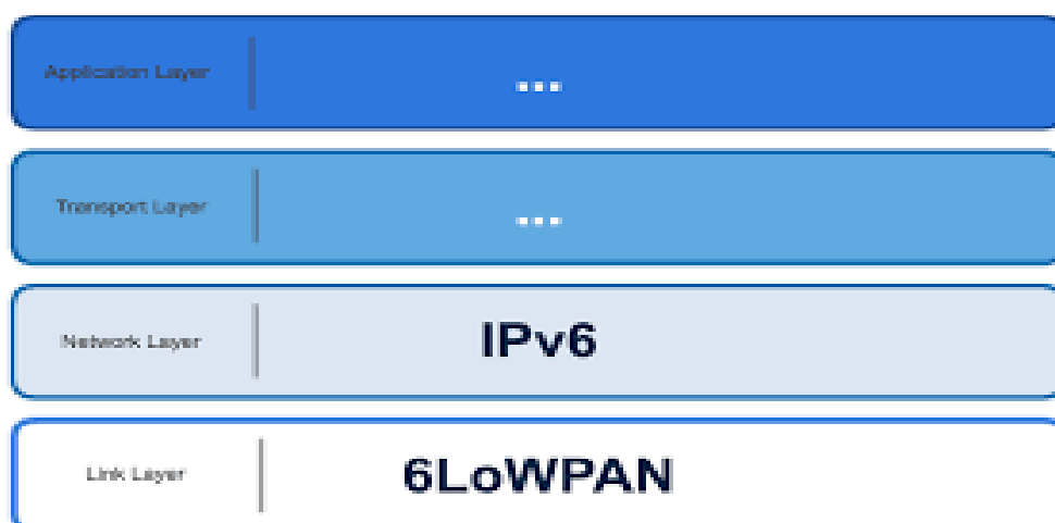
Fig. 1.7 6LoWPAN layer stack[25]
