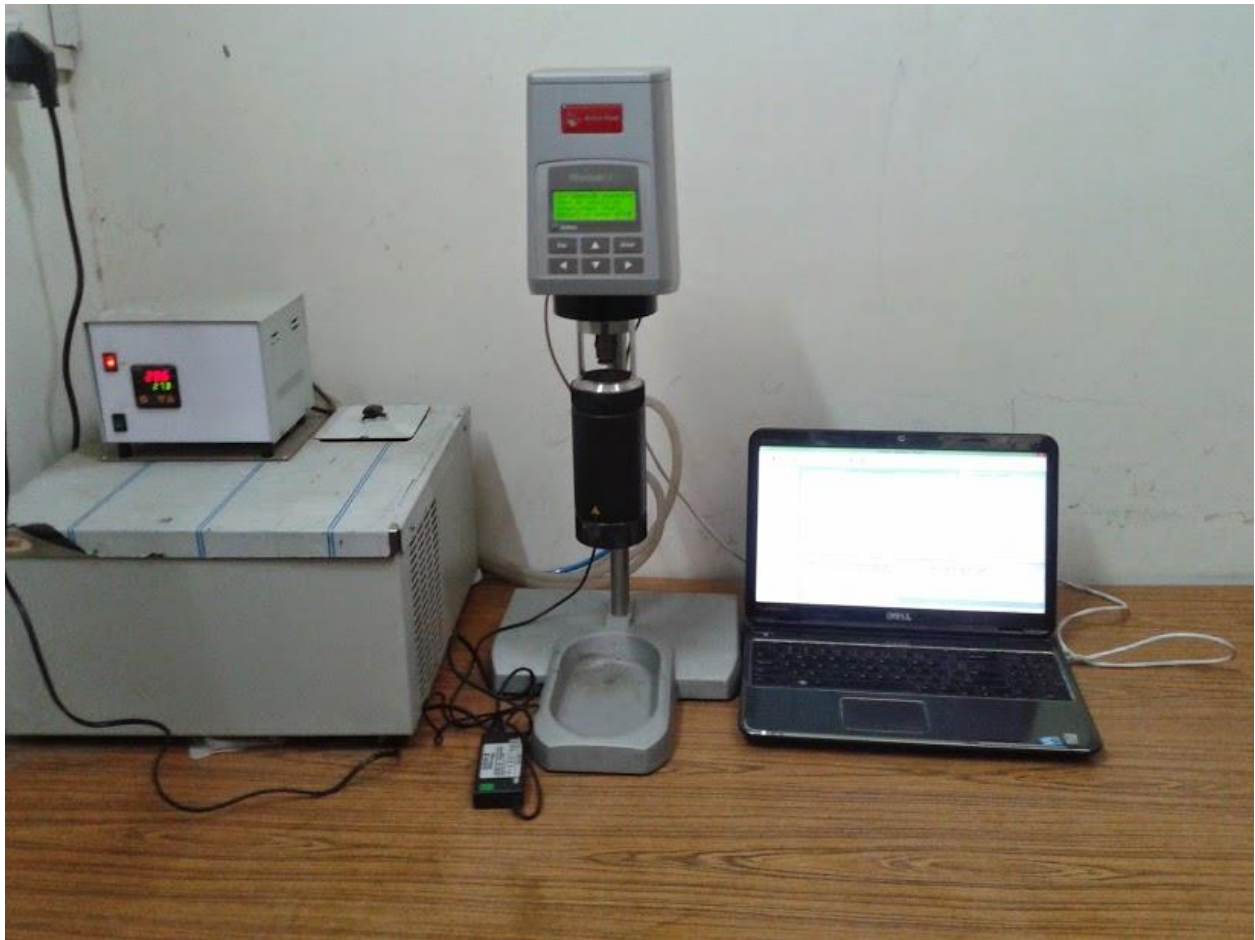
Fig. 4.1: Anton Paar RheolabQC rheometer
