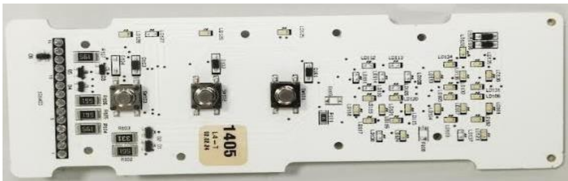
Fig 3.1 ThinQ Display PCB
