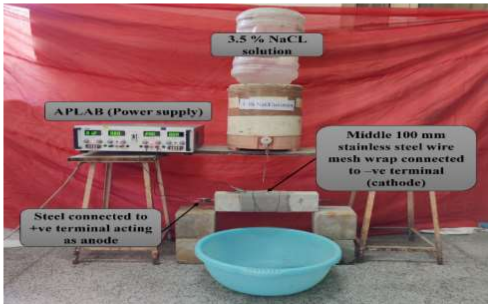
(b) Actual corrosion set up
