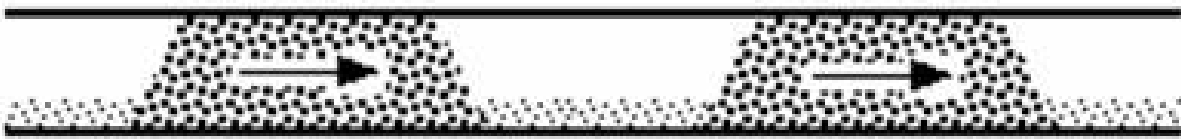
Fig 2.3: Low velocity slug flow (Wypych et al., 1990).
