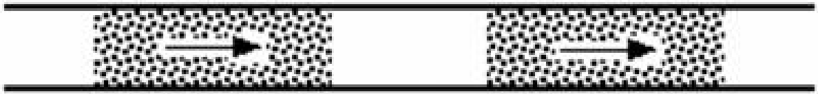
Fig 2.4: Low velocity plug flow (Wypych et al., 1990).
