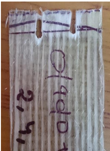
(d) E/D= 2 , K/D= 4 , P/D= 5 with shear out mode of failure
