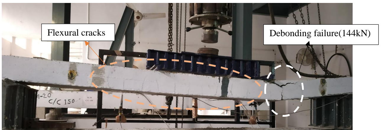
Fig 4.12 Failure of the Slab SA
