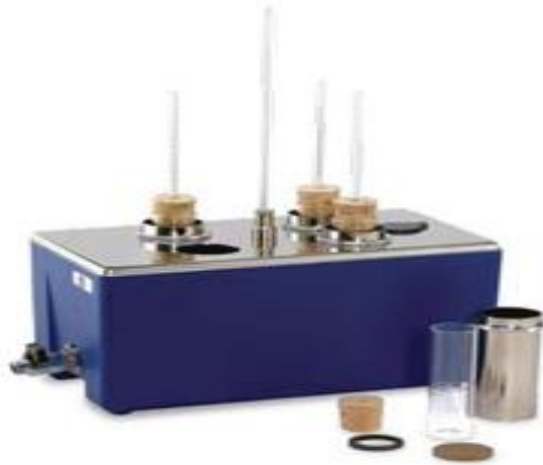
Figure 3.9: Cloud and pour point apparatus
