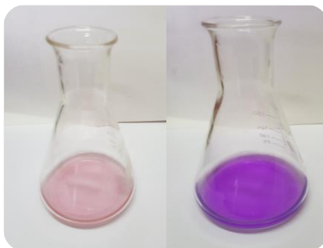
Fig 3.8 Calcium estimation by EDTA titration
