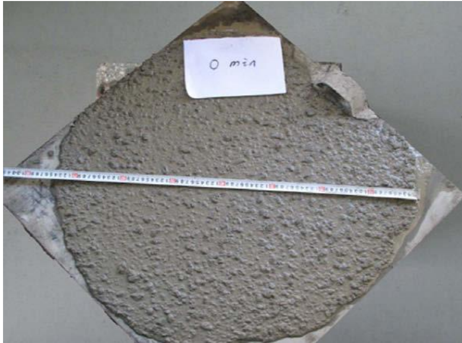
Fig. 2.2 : Slump flow test (Zhimin et al.,2008)
