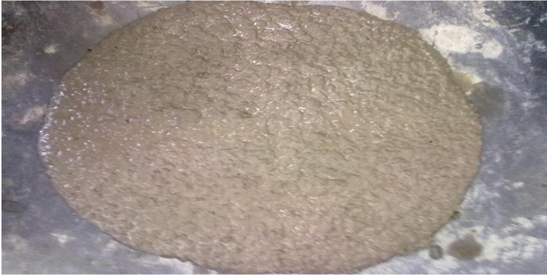
Fig. 5.1 : Slump Flow Test
